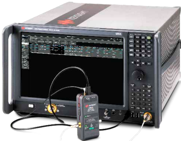
图 17. 配备了 RCal 的信号分析仪。RCal 只有手掌大小，并通过 USB 接口上电和控制
