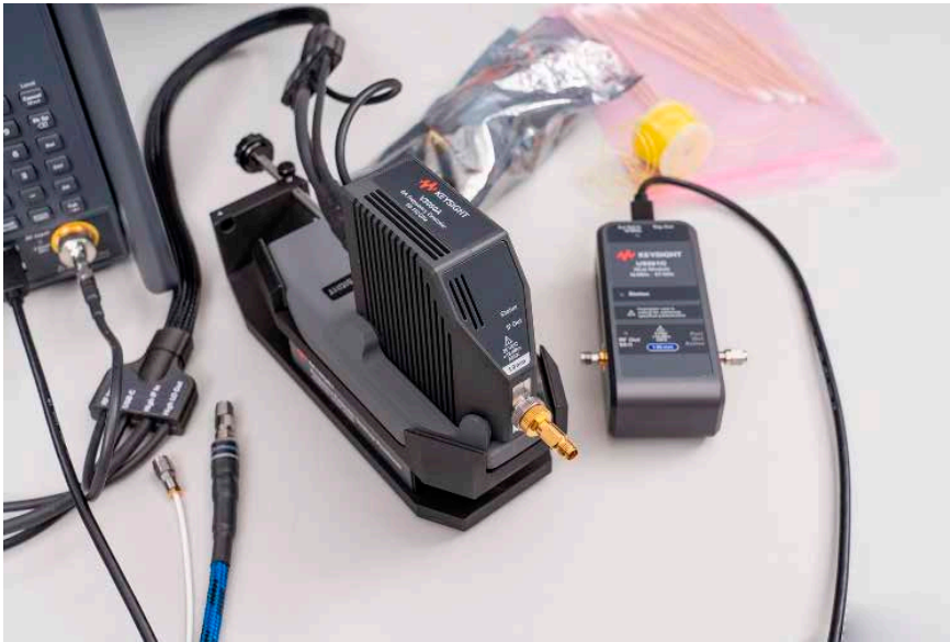
图 9. Keysight V3050A 扩频器 (中) 和 U9361 RCal 接收机校准仪 (右) 实现创新的毫米波测试和测量
