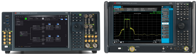
图 2. 这个 5G 测试台配置支持生成高达 44 GHz 的 3GPP NR 信号, 以及传统台式仪器所提供的高达 50 GHz 的频谱分析。这两种仪器均支持 1 GHz 带宽的综合功能。
