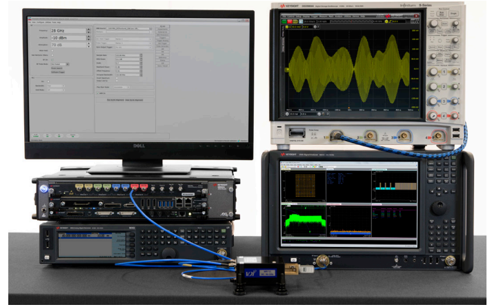
图 4. 这个 5G 测试台配置凭借 +5 GHz 以上的超宽带宽, 能够准确生成和分析 50 GHz 至 110 GHz 的信号。M8195A 任意波形发生器为外部混频器提供直接 IF 信号, 同时 N5183B MXG 微波模拟信号发生器提供 LO 信号, 用于上变频至毫米波频率。N9041B UXA 信号分析仪可以将高达 1 GHz 的信号带宽直接数字化, 以便进行分析。UXA 的宽带 IF 输出使示波器能够分析 +5 GHz 带宽的信号。
